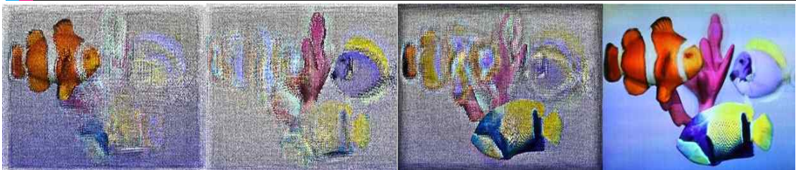
*주: 좌측 3개의 LCD 영상 패널을 이용해 맨 우측의 고해상도, 다시점에서 시청 가능한 3D 영상을 구현
